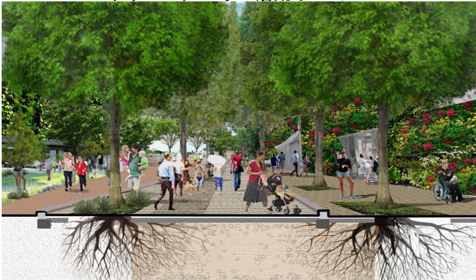
樹木と植栽基盤が持ち合わせる機能を活用。樹冠が緑陰を提供し、基盤は根系伸張スペースとなり、健全な樹木を育む。基盤は雨水貯留機能を有し豪雨対策となる。ヒートアイランド緩和と大雨対策、健全な樹木の育成、すぐれた景観は、安全安心を提供し、にぎわいをもたらす。
